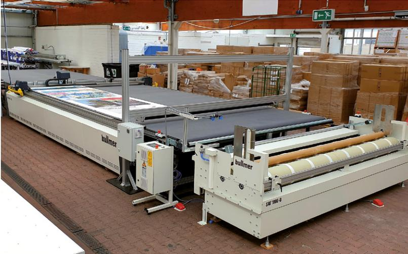
Bei der Firma Comdatek hat Bullmer zwei Premiumcut-Maschinen mit einer Breite von 3,2 Metern und eine mit fünf Metern Breite verbaut.
